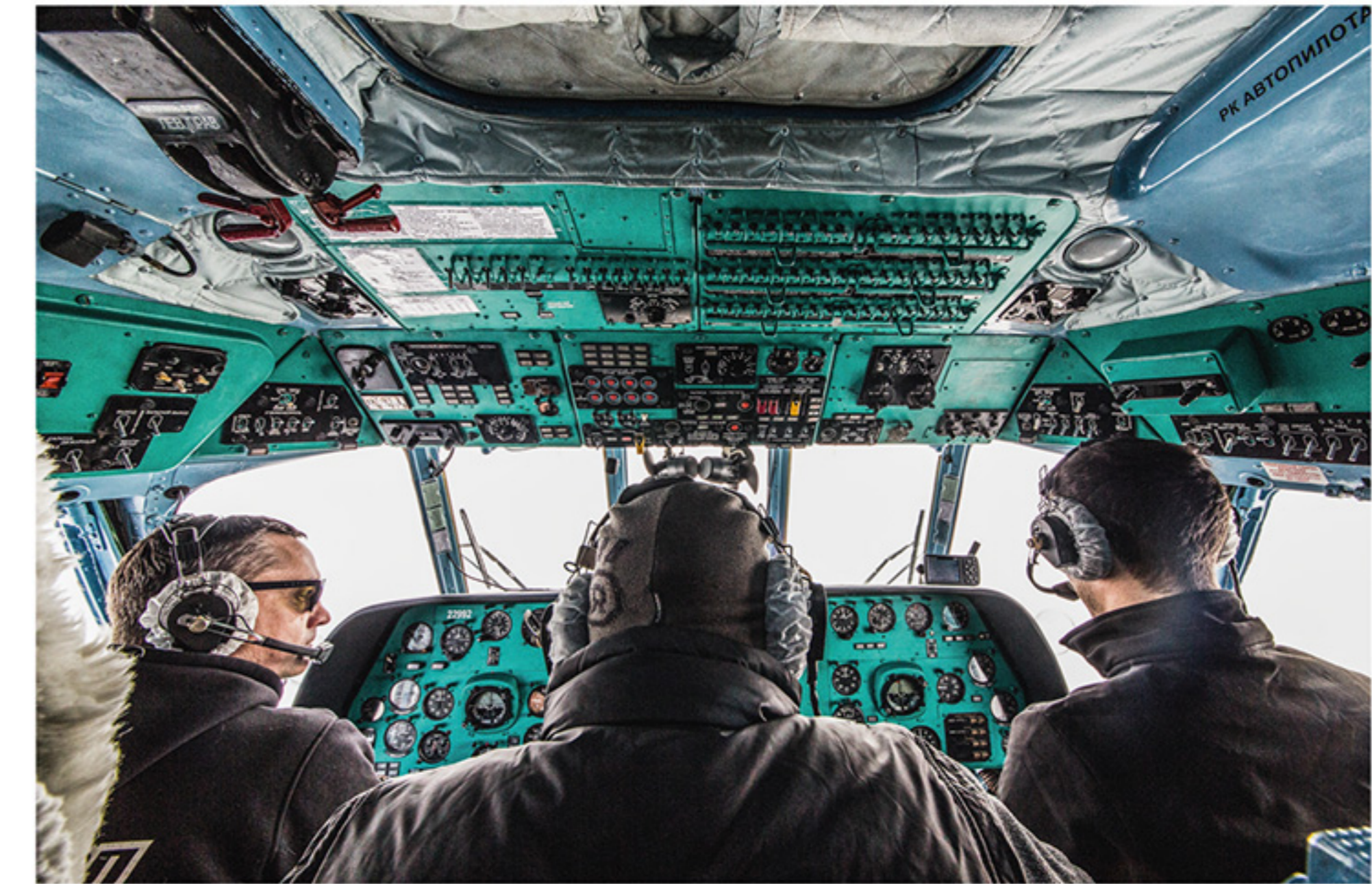
Relais und Kippschalter statt blinkender Elektronik und leuchtender Digitalanzeigen im Mehrzweckhubschrauber Mi-8. Die 18 Meter lange Hochgebirgsversion hat neben Pilot und Co-Pilot immer auch einen Bordingenieur an Bord
